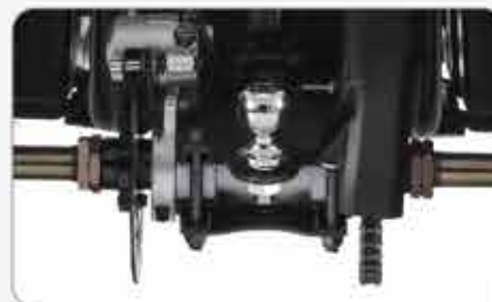
04 Задна алуминиумска ооска со висок интензитет и отпорност на напрегања
