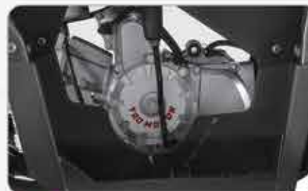
04 5,8 КС 125cc автоматски мотор со менувач за рикверц
